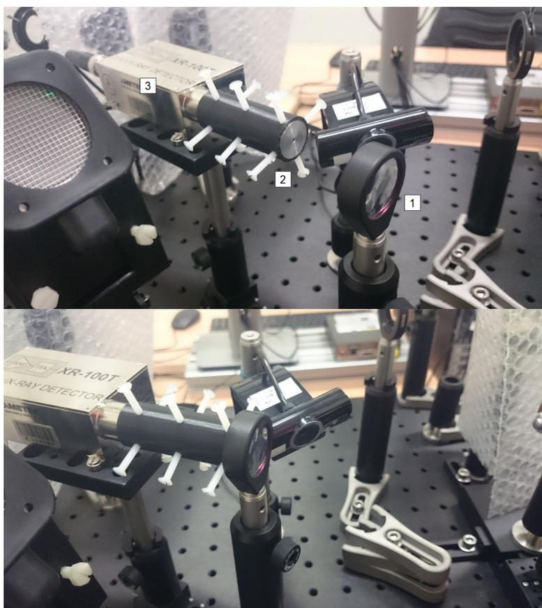
**Fig. Exp2:** Elementos del sistema de detección: atenuador (1), colimador (2) y detector (3). Se muestran separados (arriba) y en la configuración de medida (abajo).
